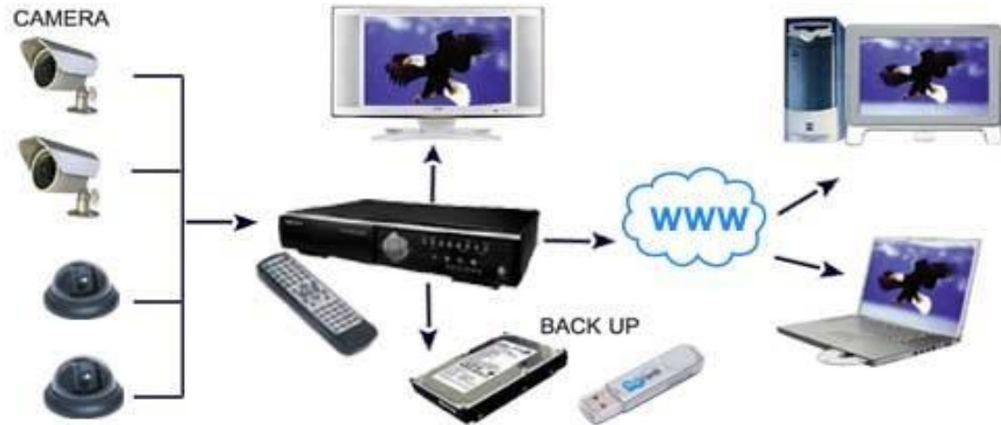
รูปที่ 7 แผนผังการเชื่อมต่อระบบกล้องวงจรปิดแบบระบบอะนาล็อก (Analog)
